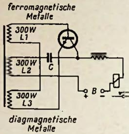
Rechts: Bild 2. Schaltung eines Metallsuchgerätes, das zwischen ferro- und diamagnetischen Stoffen unterscheidet
