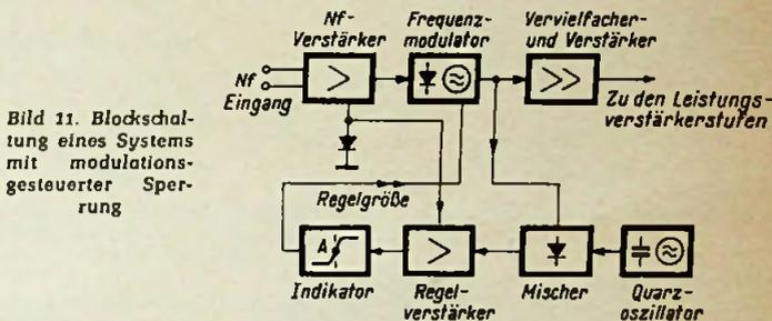
Bild 11. Blockschaltung eines Systems mit modulationsgesteuerter Sperrung
