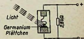
Belichtung des Kontaktes einer Germaniumdiode
