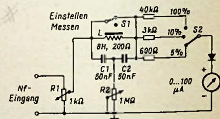
Bild 4. Schaltung des direkt anzeigenden Verzerrungsmessers
