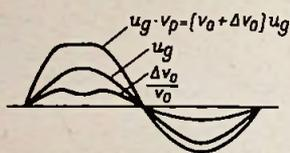
Bild 7. Eingangsspannung, Ausgangsspannung und Verstärkern innerhalb einer Periode
