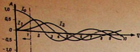
Bild 3. Seitenbänder bei der Frequenz-Modulation
