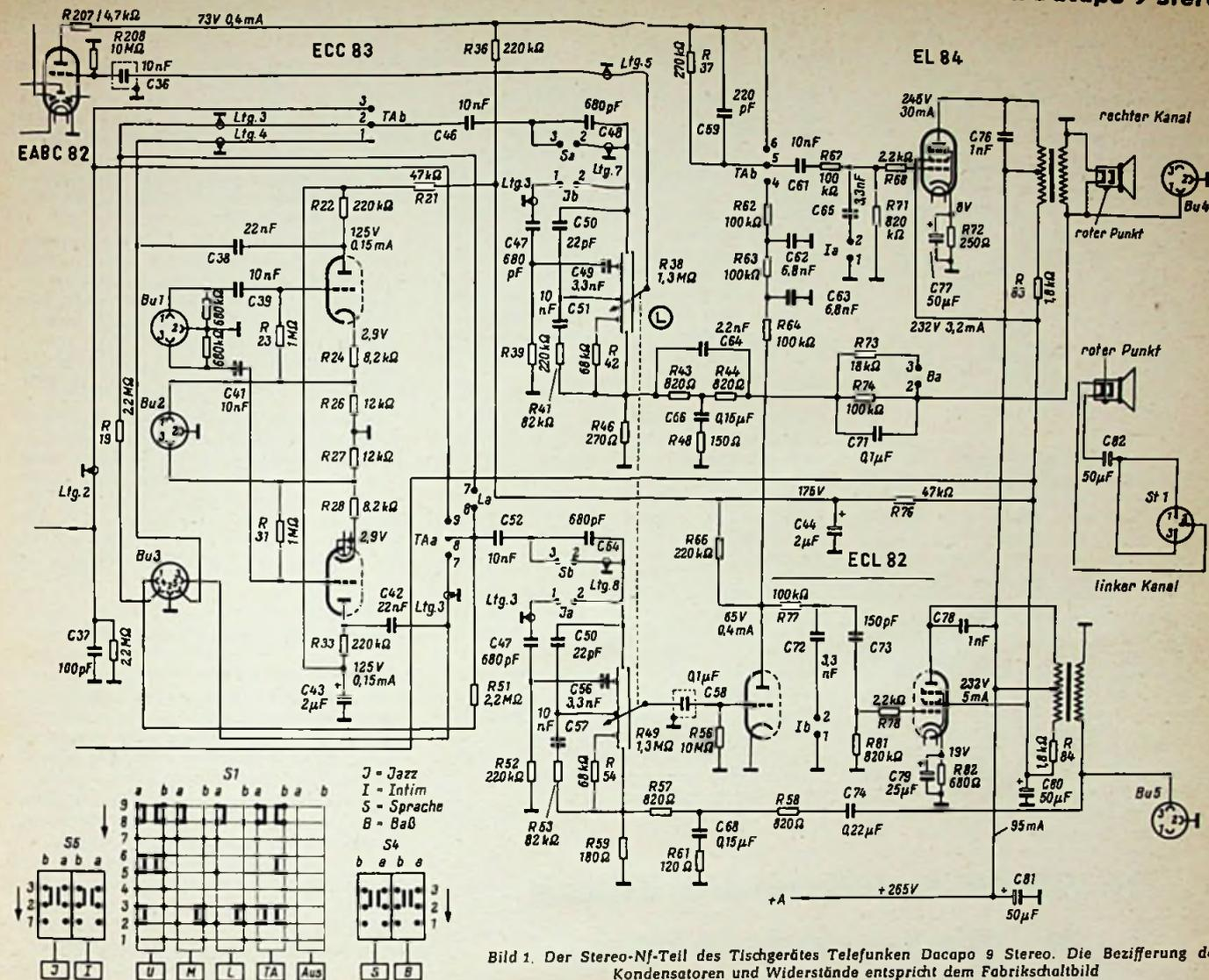
Bild 1. Der Stereo-Nf-Teil des Tischgerätes Telefunken Dacapo 9 Stereo. Die Bezifferung der Kondensatoren und Widerstände entspricht dem Fabrikschaltbild
