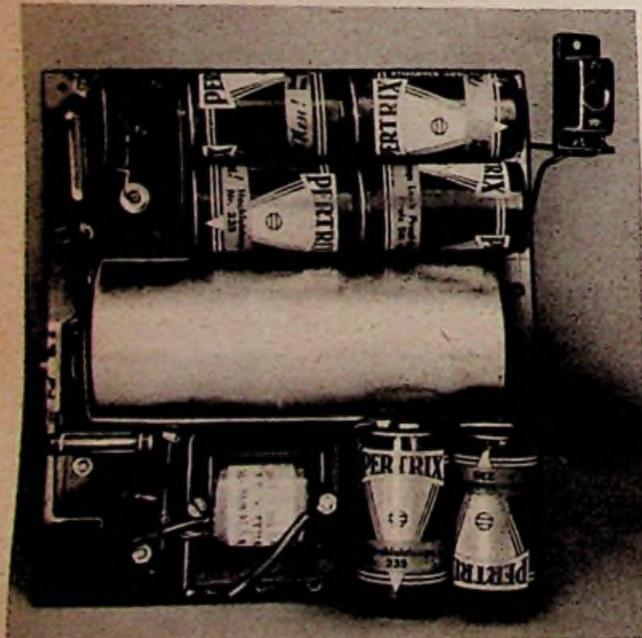
Bild 8. Stromversorgungsteil von der Batterieseite aus gesehen
