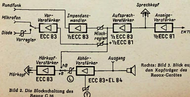
Bild 2. Die Blockschaltung des Revox C 36
