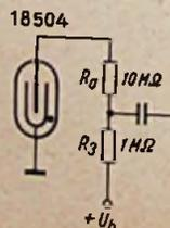
Rechts: Die von Valvo empfohlene Schaltung für das Geiger-Müller-Zählrohr
