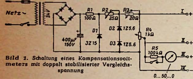
Bild 1. Schaltung eines Kompensationsvoltmeters mit doppelt stabilisierter Vergleichsspannung
