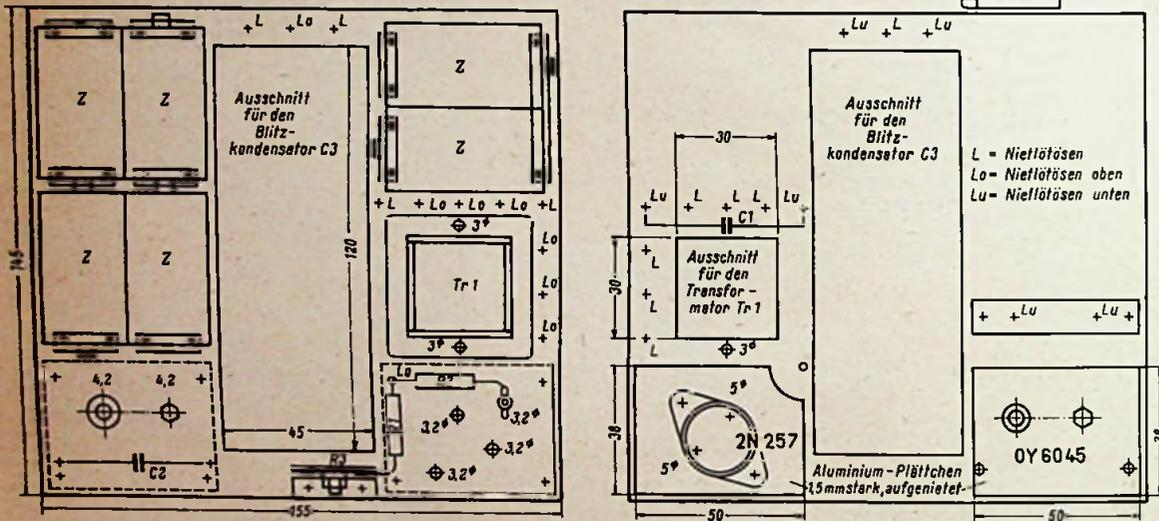
Bild 7. Montagebrett des Stromversorgungsteiles (3-mm-Hartpapier)
