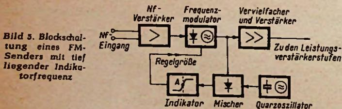
Bild 5. Blockschaltung eines FM-Senders mit tief liegender Indikatorfrequenz
