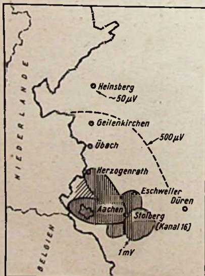
Bild 1. Feldstärkeverlauf um den UHF-Sender Aachen-Stolberg (Kanal 16). Die Feldstärkekonturen wurden mit einer 10-Element-Yagi-Antenne gemessen
