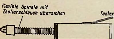
Bild 1. Ein batteriebetriebener Gasanzünder läßt sich durch Einsetzen eines Glühlämpchens gut zum Durchleuchten gedruckter Schaltungen verwenden
