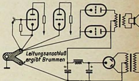
Bei der ersten Inbetriebnahme trat ein leichtes, aber doch störendes 100-Hz-Brummen auf. Die Fehlersuche blieb erfolglos, bis schließlich die Minusleitung der Elektrolytkondensatoren von der einen Lötöse mit den übrigen Nulleitungen unmittelbar am zweiten Flügel zusammengelötet wurde. Daraufhin war die Störung restlos beseitigt.
