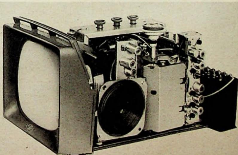
Bild 1. Versuchs-Fernsehempfänger der Texas Instruments Inc. mit durchgehender Halbleiter-Bestückung (Ausnahmen: 23-cm-Bildröhre und Hochspannung-Gleichrichterdiode). Rechts im Bild der 12-V-Akkumulator
