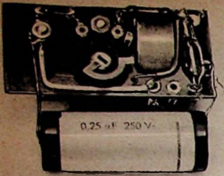
Bild 6. Schaltbrettchen für den Blitzstab-Teil
