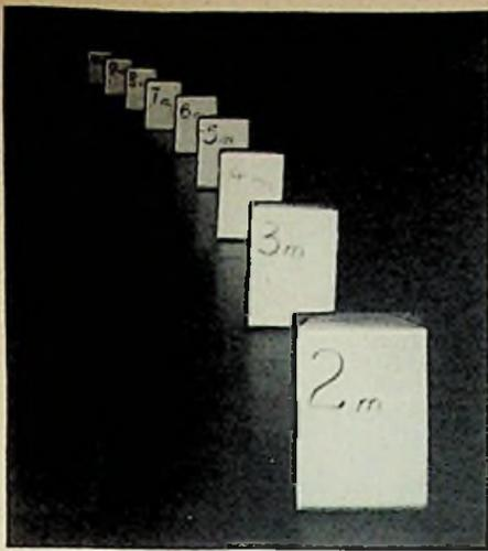
Bild 10. Testaufnahme zur Ermittlung der Leitzahl
