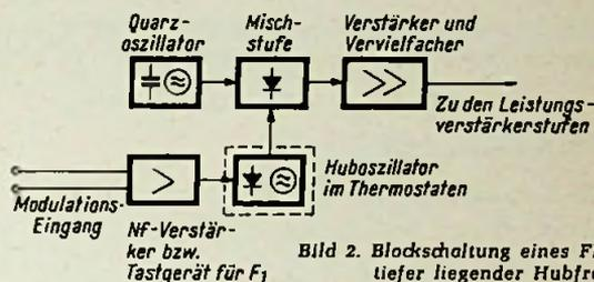
Bild 2. Blockschaltung eines FM-Senders mit tiefer liegender Hubfrequenz
