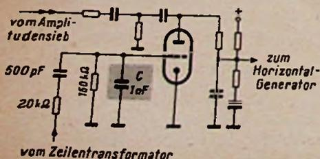
Durch den zeitweisen Feinschluß des Kondensators C wurde der Vergleichs-Impuls aus dem Zeilentransformator kurzgeschlossen
