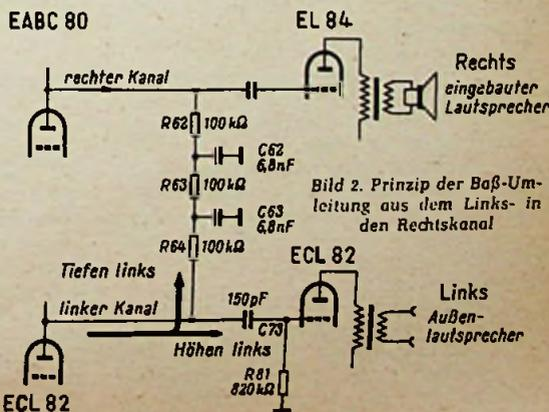
Bild 2. Prinzip der Baß-Umleitung aus dem Links- in den Rechtskanal
