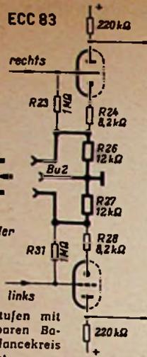
**Bild 4. Prinzip der Vorstufen mit dem nachträglich ansteckbaren Balance-Ferrnregler.** Der Balancekreis ist stark gezeichnet
