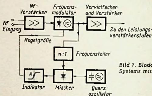
Bild 7. Blockschaltung eines Systems mit Frequenzteiler
