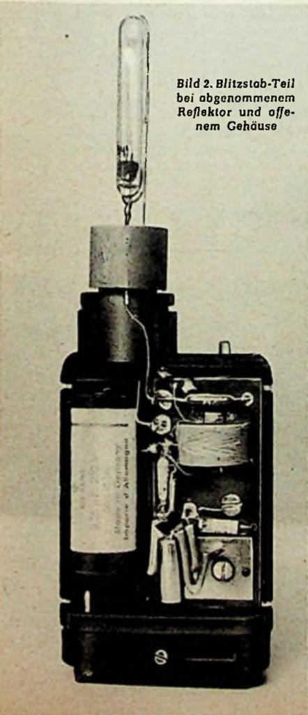
Bild 2. Blitzstab-Teil bei abgenommenem Reflektor und offenem Gehäuse
