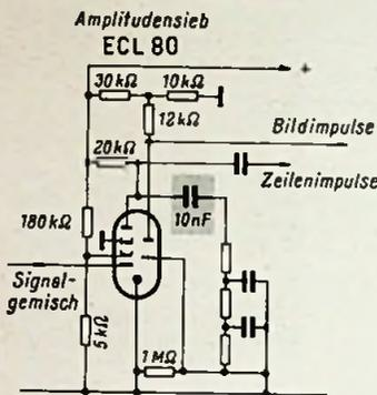
Die schwache Synchronisation der Bildablenkung wurde verursacht von dem schadhaften 10-nF-Kondensator, der eine geringe positive Vorspannung an das Triodengitter gelangen ließ
