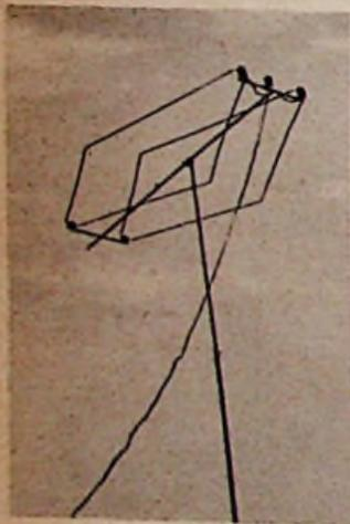
Bild 3. Versuchsaufbau einer Doppel-Rhombusantenne hoher Bandbreite
