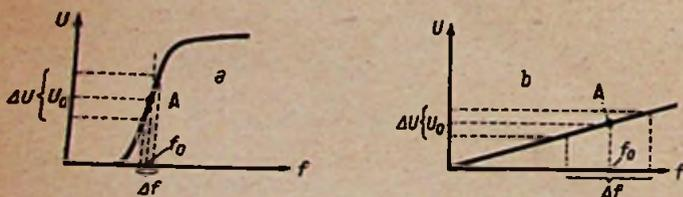
Bild 6. Verschieden steile Modulationskennlinien
