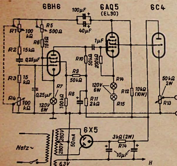
Der Widerstandswert von R3 ist derart einzustellen, daß am Potentiometer R4 eine Spannung von 10 V liegt. Sie kann zwischen 25° und 55° C mit einer Genauigkeit von 0,002 V eingehalten werden.
