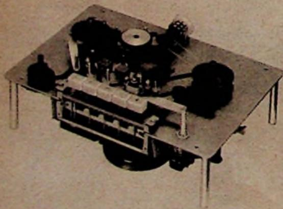
Bild 6. Draufsicht auf das Magnetton-Laufwerk des Thaleswerkes
